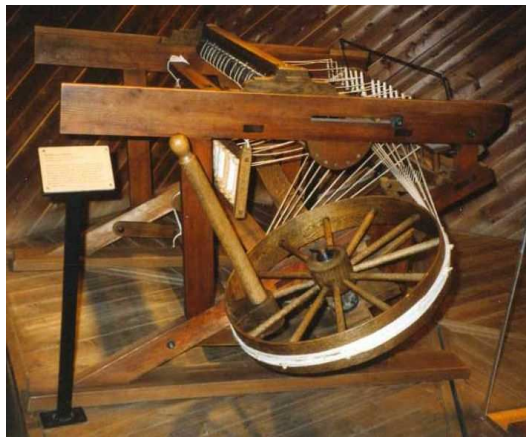
La « spinning-jenny » de James Hargreaves, inventée en 1765, décuplait la productivité du fileur ; 20 000 furent vendues avant 1790
